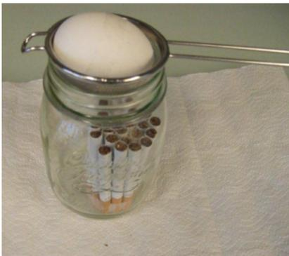
Placer env. 20 cigarettes dans un bocal de confiture. Les allumer toutes simultanément. Au-dessus du verre, placer une passoire métallique dans laquelle se trouve un œuf dur. Au préalable, coller une petite bande autocollante du côté de l'œuf qui est exposé à la fumée.
